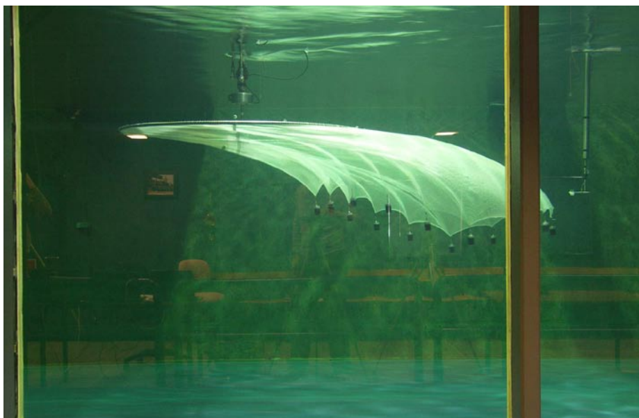
Figur 3. Modelltesting av merd med not under ulike strømhastigheter i sirkulasjonstank i Hirtshals, Danmark (Foto: SINTEF).
